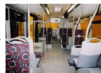
フルフラットバス 車内に段差がないため移動しやすく、車内事故の低減も期待される。
