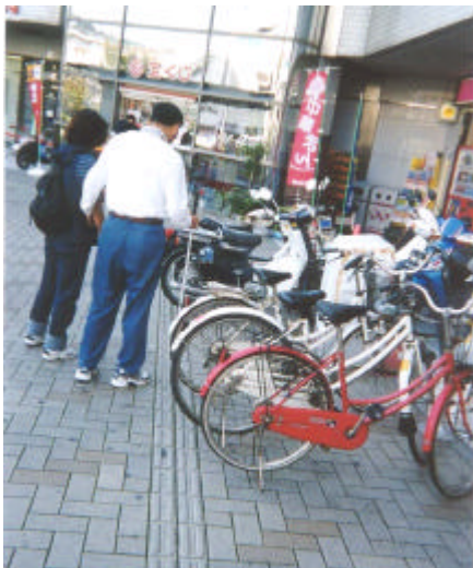
誘導ブロック上の障害物 誘導ブロック上の駐輪
