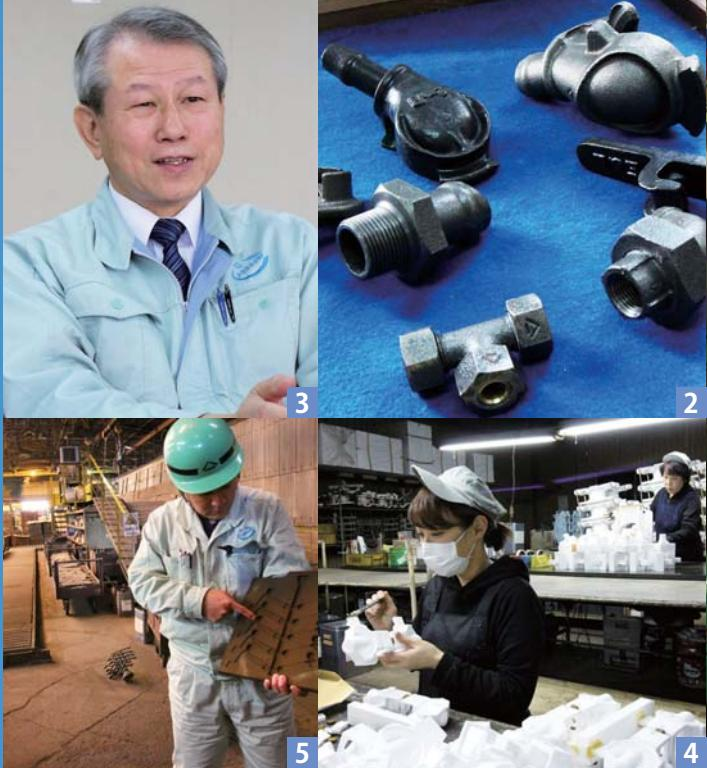
1高周波誘導炉で溶解された鉄鉱を運ぶ作業 2鉄道車両部品の数々 3会社の歴史や今後への思いを語る吉年社長 4消失模型铸造法による铸造のため、発泡スチロールの模型を組み立てる従業員 5薄い鉄物を製造するための铸造
