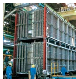
▲熱交換器の一種であるガス式給水予熱器は発電所やごみ焼却場などの排煙熱の回収に使用される。
