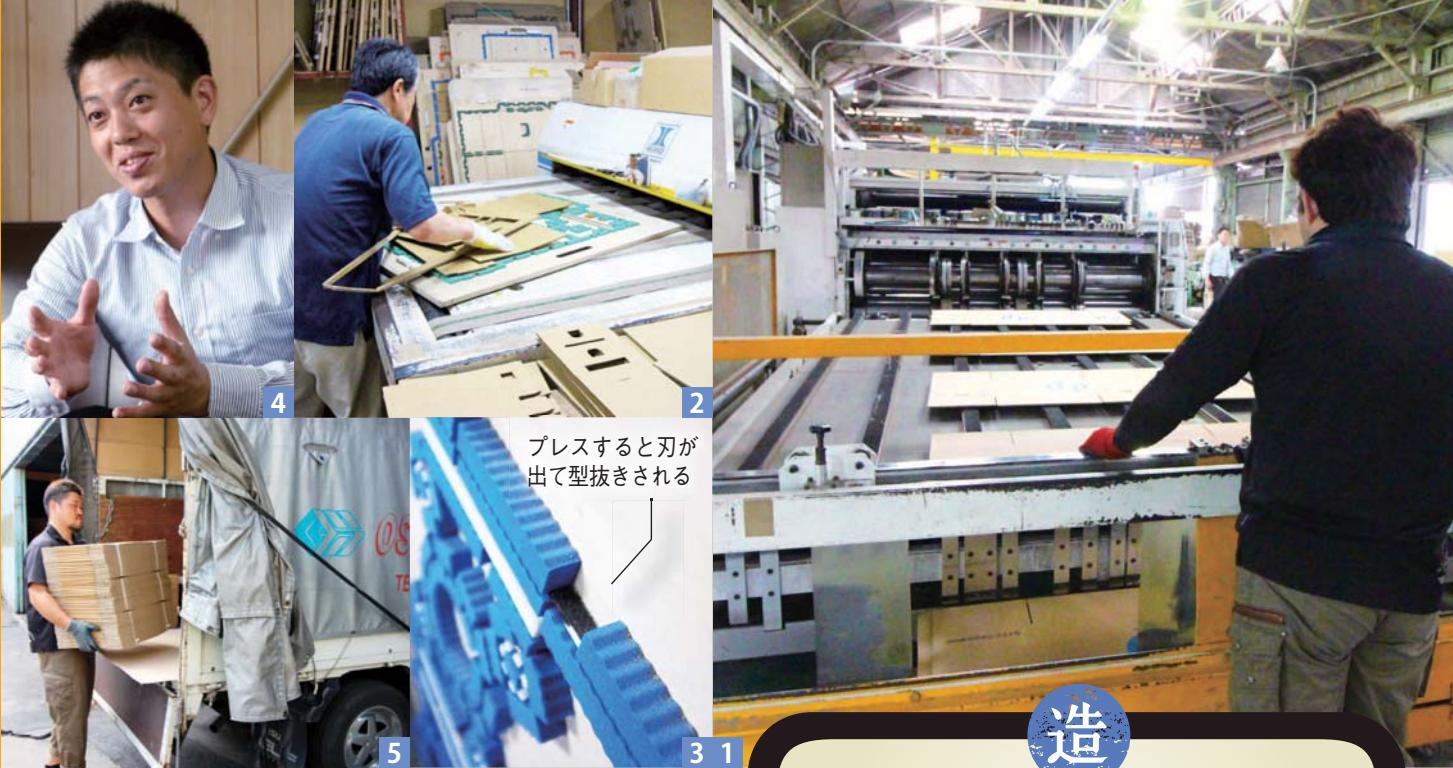
1 ダンボール箱の印刷・裁断作業 2 3 様々な型抜き加工のため刃が取り付けられた木枠を使用。安全のため刃の周りにはクッションが施されている。4 最近は個人からの仕事の依頼もあり、特殊なものを作ると喜んでもらえるのが何よりも語る前田代表取締役 5 同社は自前で商品を配送している
