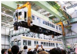
▲電車の車体と台車を切り離すクレーンは35tの重さまで持ち上げ可能。南海電車まつり(30ページ参照)で作業の見学ができる。
