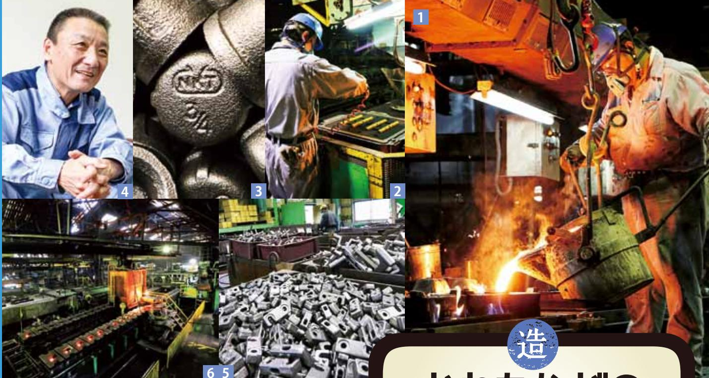
1 鋳物の型に溶けた鉄を流し込む作業 2 砂を固めた鋳型をセットする作業 3 同社のロゴが入った管継手 4 これからも可鍛鋳鉄にこだわりたいと語る菊井社長 5 多種多様な企業から依頼される鋳物製品 6 工場内の全景
