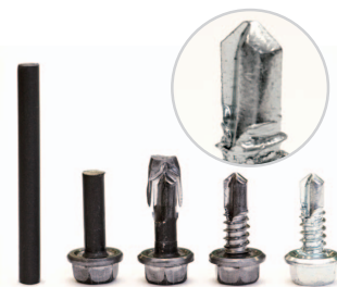
▲鉄線(左)が工程を経て「ジャックポイント」の完成品(右)となる。先端部分(拡大写真)はドリル状で鉄板を貫通する。
