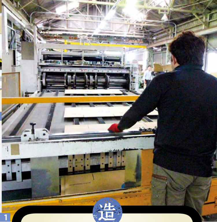
プレスすると刃が出て型抜きされる
