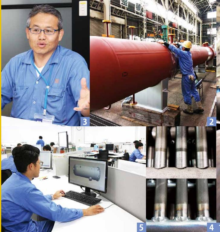
①厚肉溶接をする従業員。同社の最大の強みである高水準の溶接技術はベテランから若い人に継承される。②熱交換器の外観。内部に複数のパイプが設置される。③地元の若い人们にも、ぜひ我社で働いて欲しいと語る小林工場長。④流体が通るパイプの溶接前(写真上)と溶接後(同下)。⑤新しいオフィスで熱交換器の設計を担当する従業員
