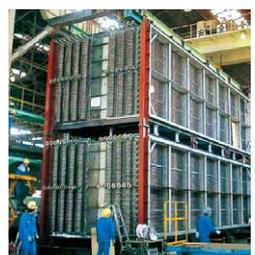
▲熱交換器の一種であるガス式給水予熱器は発電所やごみ焼却場などの排煙熱の回収に使用される。
