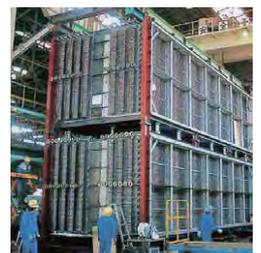
▲熱交換器の一種であるガス式給水予熱器は発電所やごみ焼却場などの排煙熱の回収に使用される。
