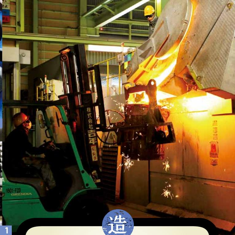
1高周波誘導炉で溶解された鑄鉄を運ぶ作業 2鉄道車両部品の数々 3会社の歴史や今後への思いを語る吉年社長 4消失模型鑄造法による鑄造のため、発泡スチロールの模型を組み立てる従業員 5薄い鑄物を製造するための鑄型
