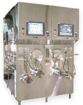
▲タッチパネル式全自動アイスクリームフリーザー。1時間に2～3万個分のアイスクリームが製造できる
