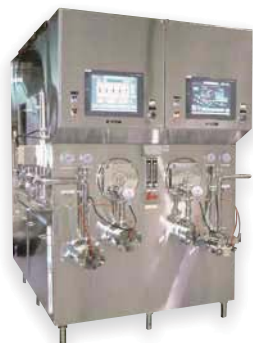
▲タッチパネル式全自動アイスクリームフリーザー。1時間に2～3万個分のアイスクリームが製造できる
