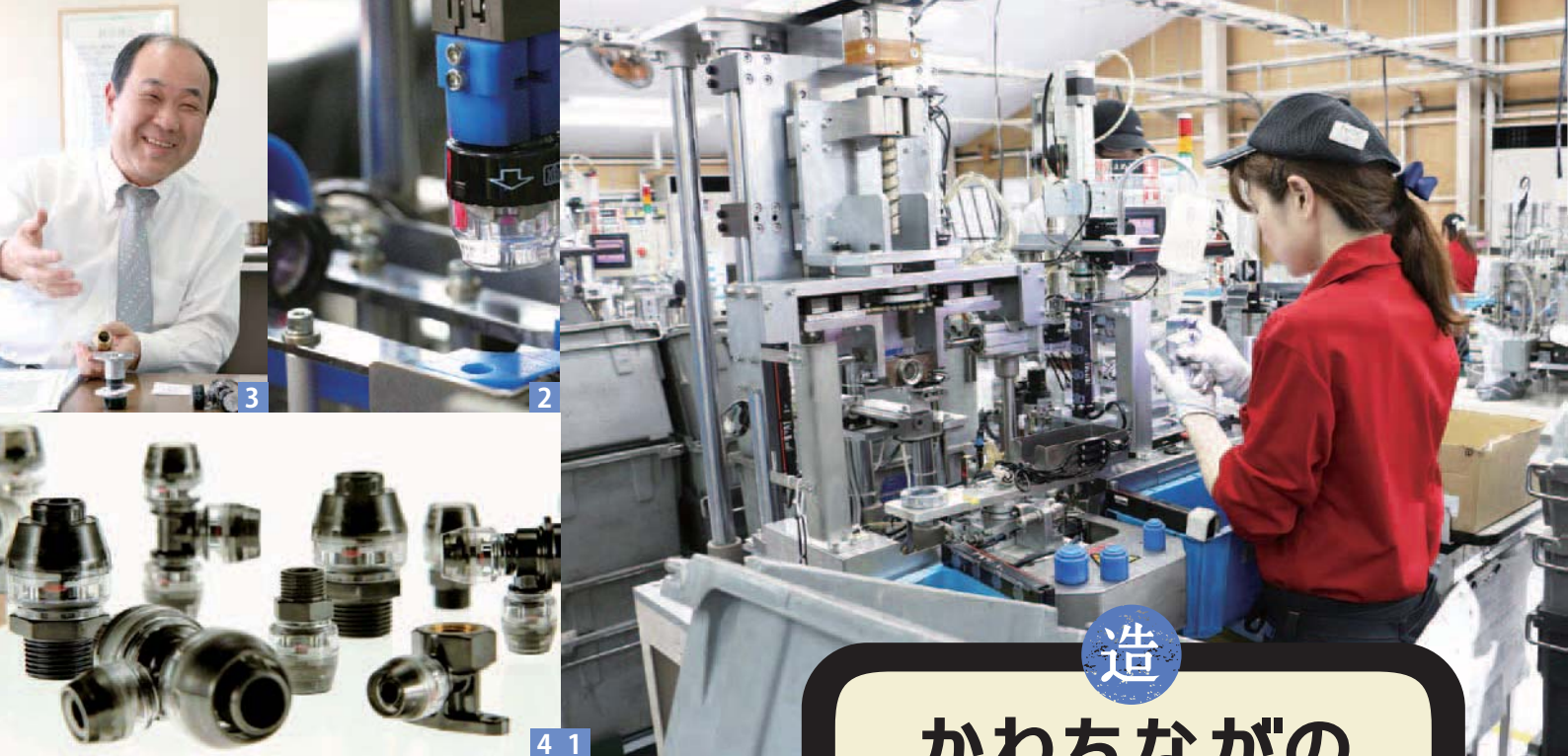
1 2 オリジナル製品をつくる設備の大半は自社技術で賄います 3 製品を説明する井上佳典社長 4 樹脂管用の「スナップ継手」
