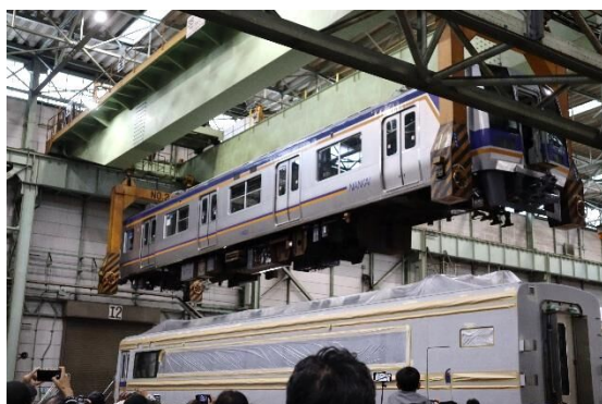
車両吊下げ作業イメージ
