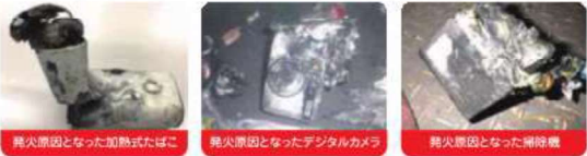
発火原因となった加熱された電池、発火原因となったデジタルカメラ、発火原因となった掃除機
