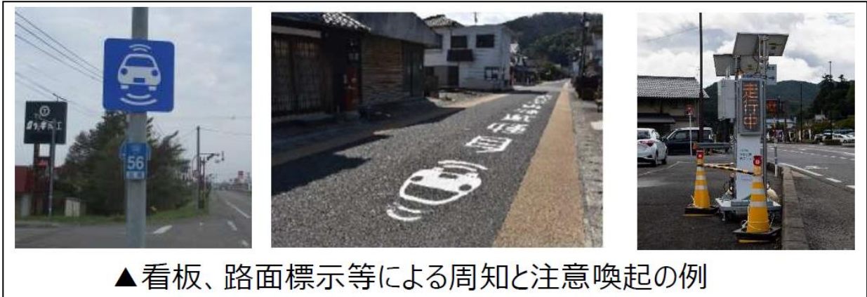
▲ 看板、路面標示等による周知と注意喚起の例 「地方部における自動運転移動サービス導入マニュアル Ver2.0」(2020.10:一般財団法人道路新産業開発機構(HIDO)作成)より抜粋
