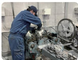
線材(コイルに巻かれた線状の金属)を釘へ加工する製釘機と呼ばれる機械の運転・操作や、製造された釘の品質検査や選別、天井クレーン・フォークリフトによる製品の運搬、製造設備等の修理・メンテナンス、金型(釘を作るための金属製の治具)の加工などの業務があり、専門的な技術や知識を身につけるとともに、手に職をつけることができます。
