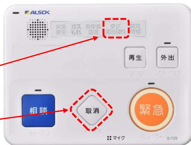
みまもりタグの電池残量が少なくなった場合は、メッセージが流れ、[タグ電池切れ]ランプが点灯します。対象製造番号のみまもりタグの電池を交換してください。交換後は[タグ電池切れ]ランプが自動で消灯します。
