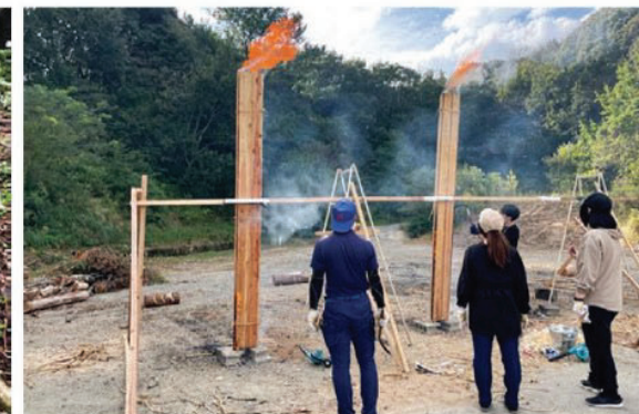
左：ワークショップによる焼杉製作。製材時に破材となる背板を外壁に活用。 右：地熱乾燥施設のある熊本県小国町。自然エネルギーである地熱を利用し木材乾燥を実現した。
