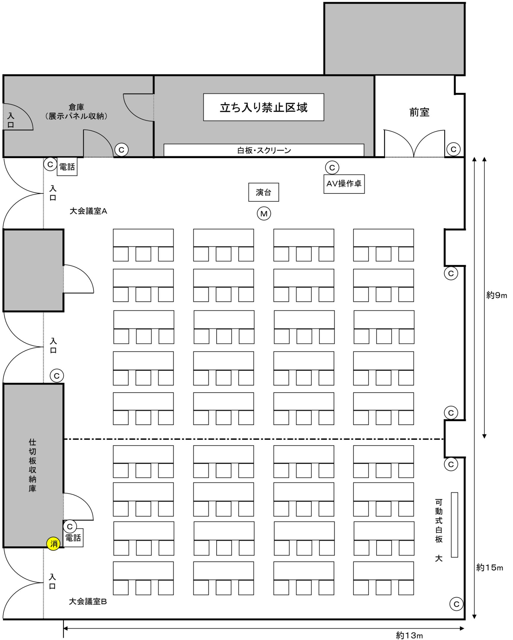
(C) はコンセント位置を表します。(消) は消火器位置を表します。(M) はマイクコンセント位置を表します。
