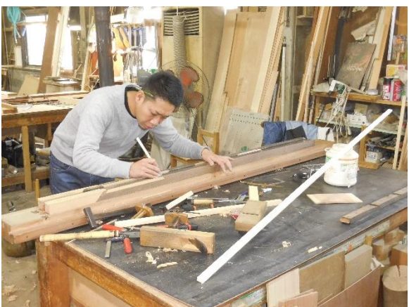
建具解体補修中
