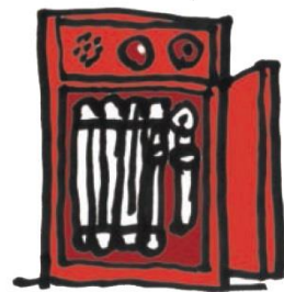
屋内消火栓設備
