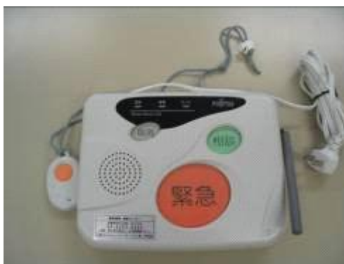
緊急通報装置
